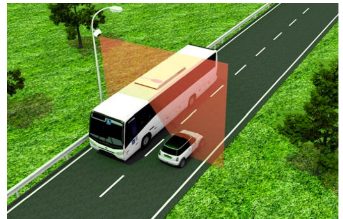
Figure 2: Installation oblique au-dessus de la voie de circulation
